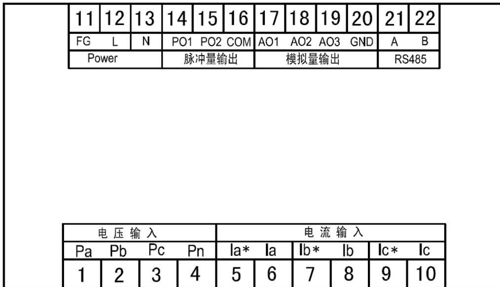
Pa、Pb、Pc、Pn: 三相电压输入
